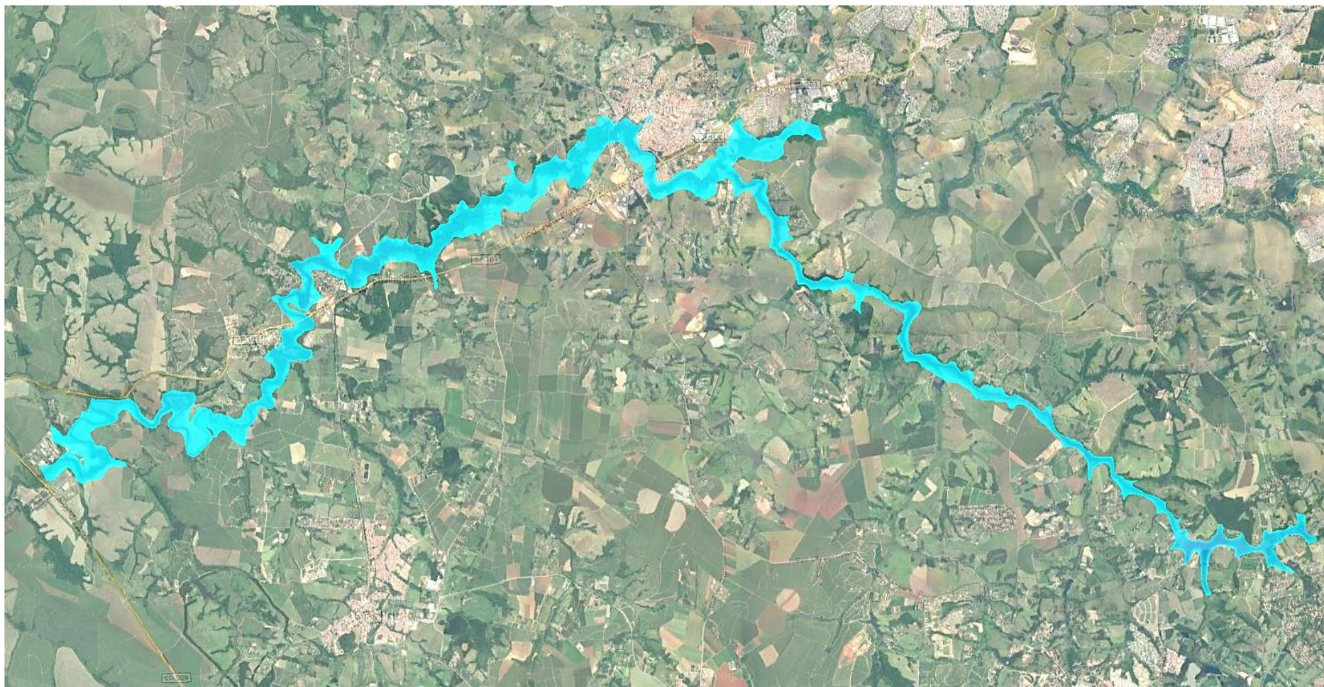
**Figura 15.6-2 – Onda de Ruptura por Galgamento (overtopping) das Barragens – Planta da Mancha de Inundação Máxima**
