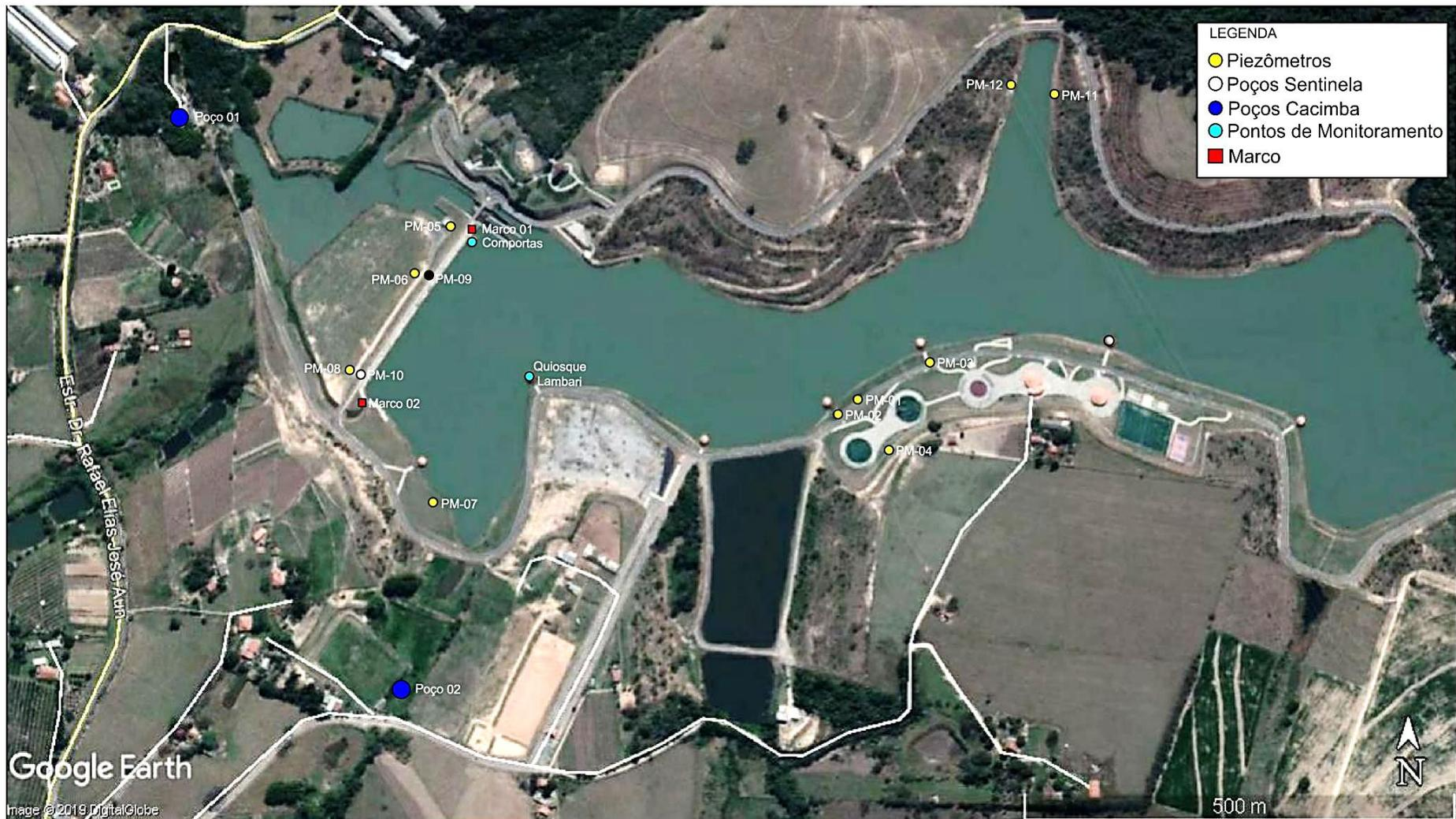
Figura 7.1 – Localização dos Piezômetros na barragem e no entorno do reservatório
