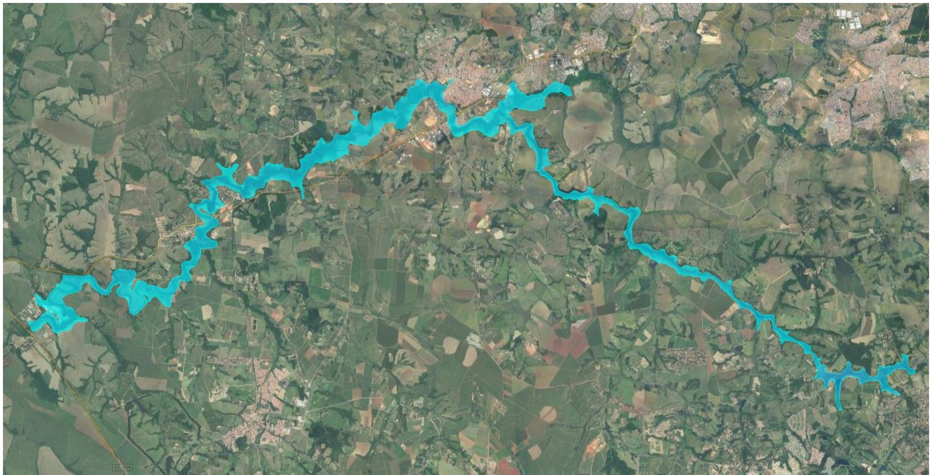
**Figura 5.1-2 – Onda de Ruptura por Galgamento (overtopping) das Barragens – Planta da Mancha de Inundação Máxima.**
